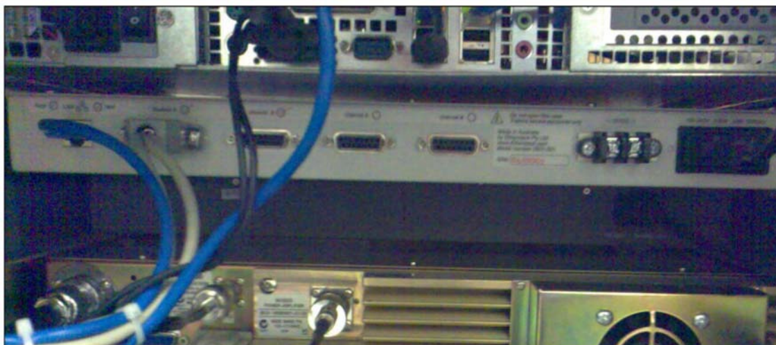
Рисунок 2. Задняя панель контроллера канала P25net
